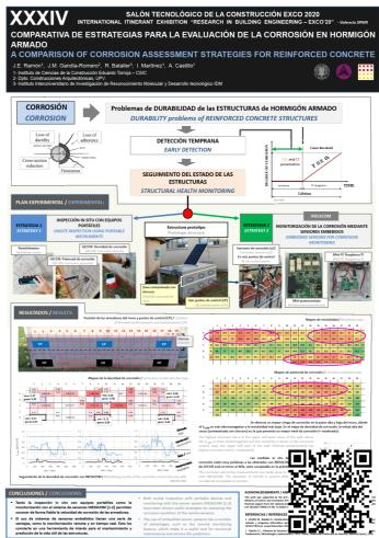
Tanto la inspección in situ con equipos portátiles como la monitorización con el sistema de sensores INESSCOM [1-2] permiten conver de forma fiable la velocidad de corrolid de las armaduras.
